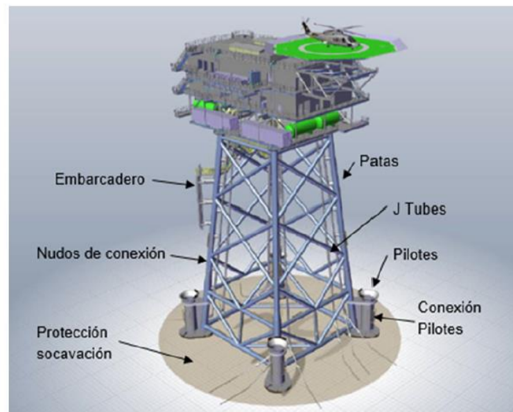
Figura 12. Estructura tipo jacket de una subestación marina. Fuente: Nordsee One GmbH
